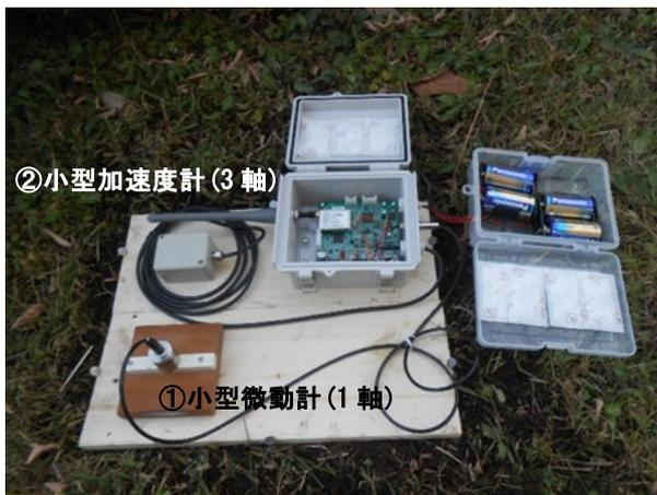
図-2 小型一軸・三軸加速度計<sup>3)</sup>
