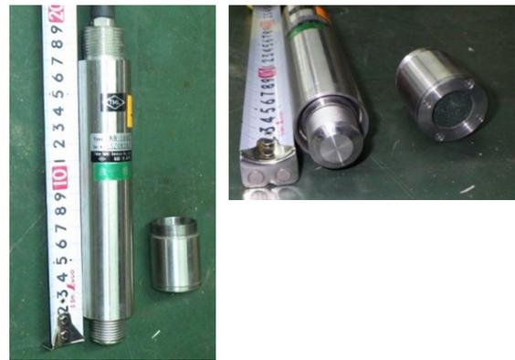
図-3 FBG光ファイバー水位計の外観
