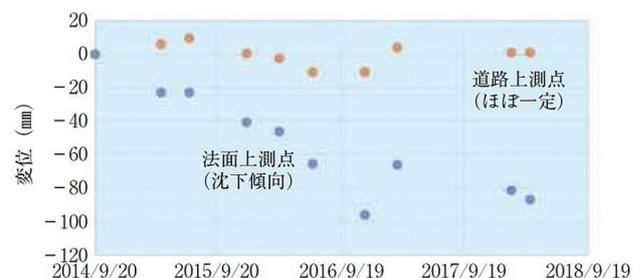
図-7 道路上測点と法面上測点の SBAS 解析変位<sup>4)</sup>
