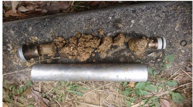
写真-8 試作コーンによる試料サンプリング状況
