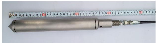
写真-7 サンプリング可能な先端コーン試作
