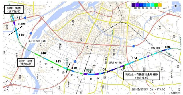
図-4 PS-InSAR 解析による道路盛土の沈下例<sup>3)</sup>
