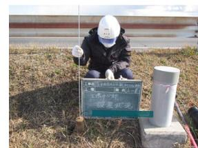
写真-2.1 土壤水分センサーの設置状況
