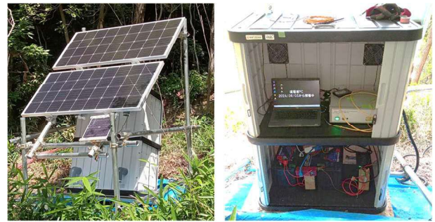
写真-4 親機とPC等を設置したソーラー発電計測小屋
