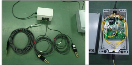
写真-2 子機（右）と配線BOXとWD5-WAT（左）
