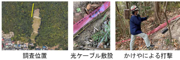
図-2 斜面での DAS 計測の概要 3)
