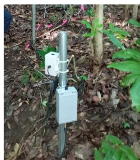
写真-3 LW8に設置したWD5-WTAと子機
