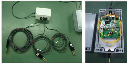
写真-2 子機（右）と配線BOXとWD5-WAT（左）
