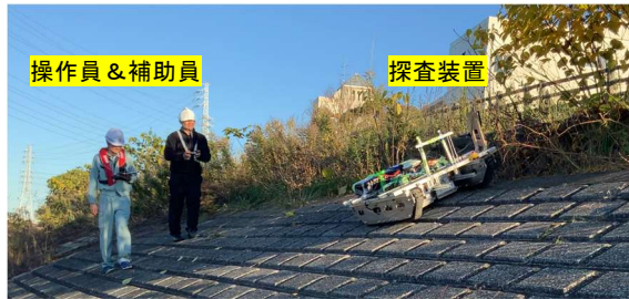
図-12 自動走行型の地中レーダー探査装置
