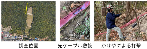
図-2 斜面での DAS 計測の概要 3)
