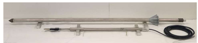
写真-1 傾斜センサプローブ（上） 土壌水分センサプローブ（下）
