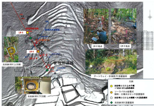
図-3 子機設置位置（LW8）と親機設置位置
