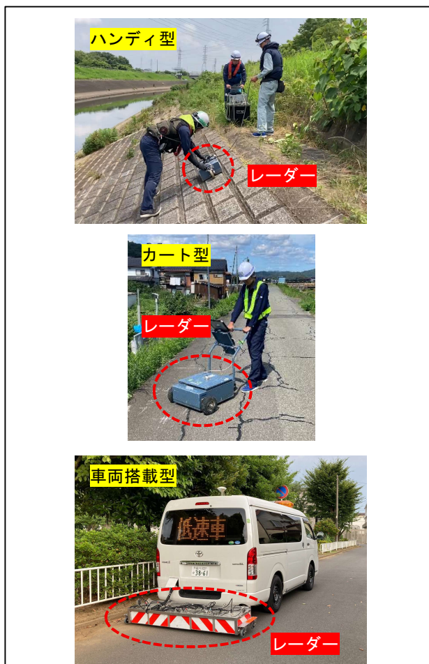
図-4 地中レーダー探査装置の例
