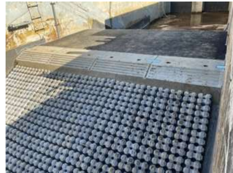
写真-4 越水実験 (越水前)
