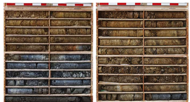
図-4 泥質片岩 BorNo1 (左) と No2(右)オールコア写真
