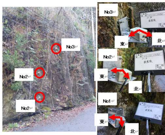
図-5 計の設置と機器方向
