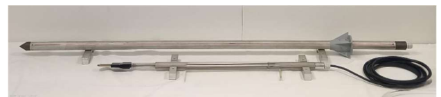
写真-2 傾斜センサプローブ（上） 土壌水分センサプローブ（下）
