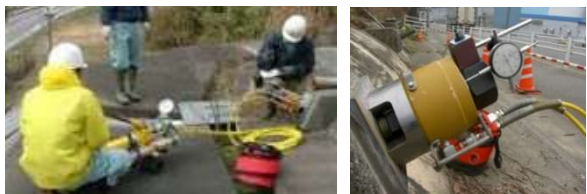
a. リフトオフ試験状況 b. ジャッキ部分
